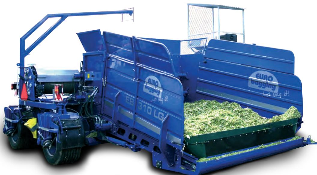
La ensiladora mas popular de su clase para ensilado de hierba, silo de maiz, pulpa de remolacha, subproductos, bagazo cervecero y pastone de maiz. El sistema unico QUICK, permite cambiar rapidamente la machina para trabajar. Comodo sistema hidraulico para accesorios con control proporcional para las principales funciones
